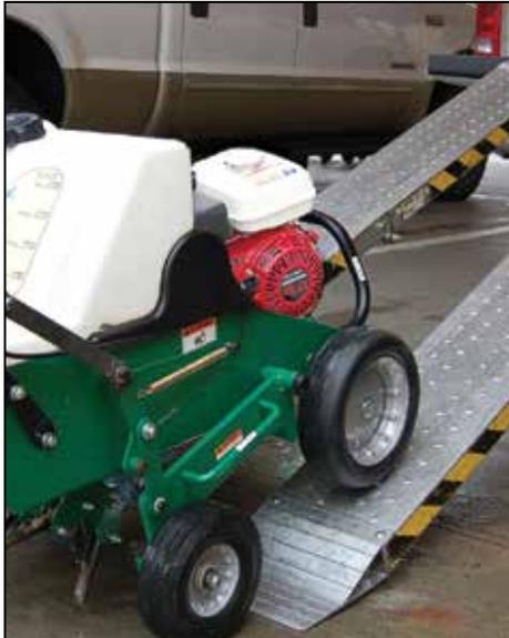
**Las ruedas de transmisión exteriores** eliminan el deslizamiento de la rueda central y el deterioro provocado por la carga por rampa con los dientes engranados.
