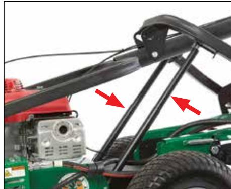
**Los soportes puntales con resortes de compresión a gas** asisten al operador al retirar la broca del orificio, lo cual reduce la fatiga.
