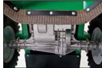
**El transeje mecánico de alta resistencia** combina la transmisión y el diferencial en un único paquete sellado sin varillajes que se enganchen en los matorrales. 3 velocidades y retroceso. La protección del lado inferior protege las correas y el área del embrague. También se incluye en la unidad hidrostática BC26.
