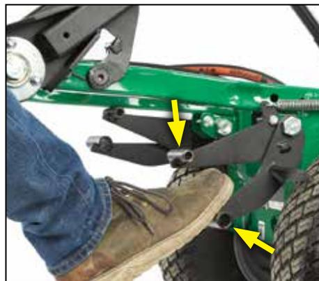
**El freno de estacionamiento con resorte**, presente en las ruedas traseras, ayuda a estabilizar la máquina, para obtener una perforación en línea recta en terrenos irregulares o inclinados. El pedal inferior activa el freno y el superior lo desactiva.
