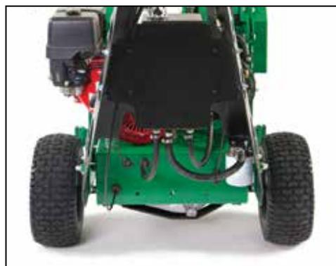
**Pendientes de hasta 20 grados** Esta unidad posee neumáticos de 15" y una base de rueda de 35" para soportar pendientes de hasta 20 grados. Los neumáticos opcionales rellenos con espuma pueden mejorar aún más los resultados. (Pieza núm. 362601)
