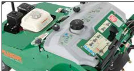
**El tanque de peso de agua (serie PL2501)** está ubicado justo sobre los dientes, para obtener una mejor profundidad de aireación y una tracción de ruedas en condiciones más secas. La capacidad del tanque lleno es de 40 libras.
