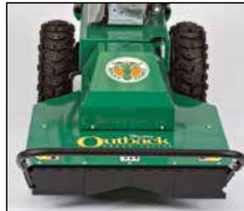
**Cubierta pivotante** La cubierta pivotante de  $\pm 12$  grados con retorno a neutro propio se diseñó para deslizarse sobre terrenos irregulares y malezas tupidas. Cubierta de 26" de ancho con mayor velocidad periférica para mejor calidad de corte.
