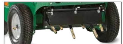
**Dientes reforzados de pared delgada, tratados térmicamente con máquinas** Su sencillo y duradero diseño de atornillado simplifica el mantenimiento. El movimiento oscilante de los dientes hacia adentro y hacia afuera produce menos compactación en la superficie interna del orificio que los diseños de cuchara. Cuatro dientes en la serie PL1801 y 6 dientes en la serie PL2501 (ilustrado). Todos tienen 5/8" de diámetro.
