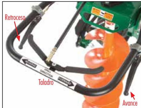
**Los controles del operador** son intuitivos, con transmisión hidrostática de velocidad variable en avance y retroceso, además del "Taladro", todo a su alcance. Los controles de transmisión son comunes en otras transmisiones hidrostáticas de Billy Goat, lo cual brinda una sensación de constancia.
