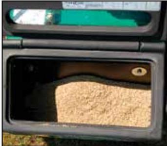
**Caja para semillas de termoplástico de 25 lb, montada en la parte delantera** con instrucciones incorporadas para el usuario, con el objetivo de simplificar el ajuste de las tasas de caída para las distintas clases de semilla. La caja y la barra de agitador no se oxidan ni se abollan, y están equipadas en la resembradora.
