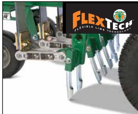
¡Los **brazos FLEXTECH™ de acción independiente** son duraderos y flexibles para una confiabilidad única! La acción oscilante permite alcanzar el doble de las profundidades de tapones de los tambores. Reduce significativamente los reclamos o la repetición del trabajo independientemente de las condiciones del suelo. Patente pendiente.
