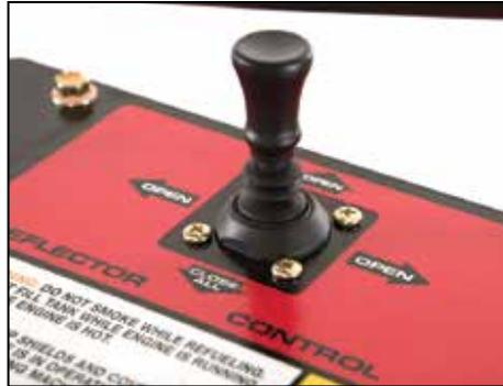
**El control deflector de la palanca de mando** permite al operador controlar rápida y fácilmente el flujo de aire desde las direcciones izquierda, derecha y adelante, lo cual elimina la necesidad de soplar en retroceso. Simplemente, jale la palanca hacia atrás para detener el flujo y proceder al traslado.
