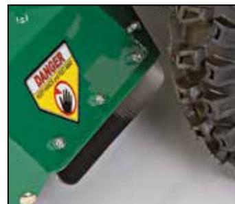
**El corte de la cubierta trasera revestido de caucho** facilita el desmonte de tocones en retroceso.
