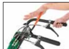
**Acoplamiento de dientes con patente pendiente EZ Drop™ (serie PL2501)** Al presionar la palanca naranja de los dientes los libera de la traba en posición elevada y engrana la acción de los dientes. Al soltar el mango de este acoplamiento, la acción de los dientes se detiene y estos se arrastran por encima de los obstáculos que se encuentran en el paso, para **no interrumpir la aireación** e incrementar la productividad (como se indica a continuación).
