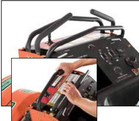
**El Quad Control Handle System™ (sistema de mango de control cuádruple) patentado** ofrece una dirección ininterrumpida en avance y retroceso, un retorno automático a posición neutral, un control integrado de presencia del operador y un freno de estacionamiento de activación automática. ¡Controles intuitivos que facilitan la operación!
