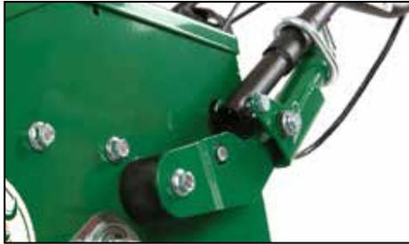
**NUEVO mango montado según las normas ISO** que ayuda a reducir la vibración, ofreciendo una operación sin fatiga para que pueda completar más trabajos en menos tiempo. (Serie PL1801).
