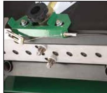
**El sistema Auto Drop™** inicia y detiene automáticamente la caída de semillas con el acoplamiento y desacoplamiento del carrete, lo que permite conservar las valiosas semillas. **El pasador de acero inoxidable con resorte** evita la sujeción en caso de obstrucción y es fácil de limpiar. Los componentes con resorte eliminan la corrosión.
