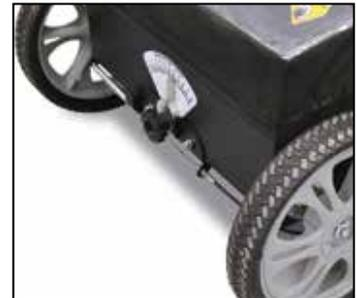
**La caja de semillas elevada** evita que la humedad obstruya la caída de semillas y proporciona una visibilidad excelente. El agitador de semillas accionado por eje elimina los sistemas de rueda sobre rueda y correas.
