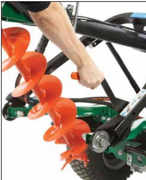
**Posición de la broca de la barrena durante el transporte y la perforación** Para un transporte compacto y eficiente, la broca se bloquea en posición de avance y despeja fácilmente el terreno para que el paso de una perforación a otra sea una tarea simple. Desbloquee ambos mangos de transporte y jale la barra de metal de liberación rápida, a fin de poner la broca en posición para una perforación vertical.
