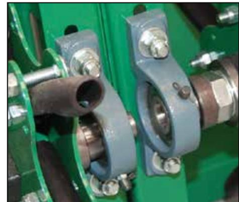
**Los cojinetes de apoyo** con engrasadores Zerk reducen el desgaste y el tiempo de inactividad para mantenimiento.
