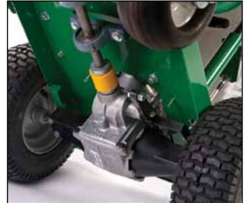
**Transmisión hidrostática** Transmisión hidrostática con infinitas velocidades de avance y retroceso, de 0 a 3 mph, y cambio de transmisión en movimiento. Alcanza lugares estrechos rápida y fácilmente. (Modelos QV550HSP y QV900HSP)
