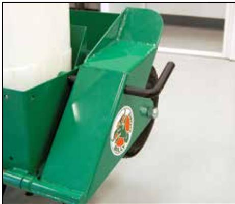
**Acoplamiento de dientes** Acople los dientes parándose sobre la base. Desacoplelos jalando de la palanca accionada por resorte.
