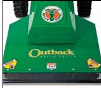
**La cubierta rígida** proporciona excelente estabilidad en vegetaciones tupidas al cortar el prado. La cubierta de descarga trasera angular elimina los paquetes y las hileras.
