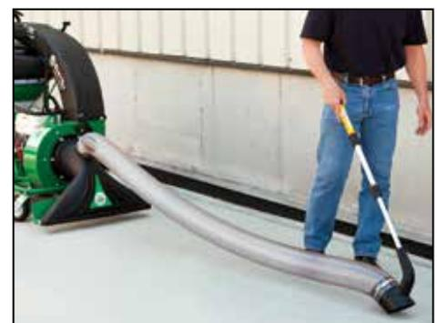
**Equipo de manguera plegable incorporada opcional con extensión de mango ergonómico** El equipo de manguera es fácil de usar y se extiende a 10' (305 cm). El cierre de la puerta de entrada magnético permite realizar el cambio sin problemas para limpiar áreas difíciles de alcanzar. (Pieza núm. 831018)
