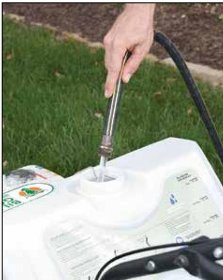
**El tanque de agua propio** elimina los pesos laterales voluminosos. La capacidad del tanque lleno es de 50 lb.
