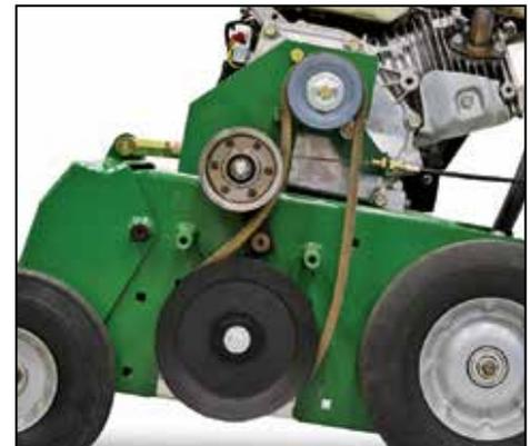
Las **poleas de alta calidad**, la polea de guía fácil de ajustar y la correa fácil de cambiar contribuyen a un mantenimiento simple y una vida útil prolongada. Cuentan con una protección de acero.
