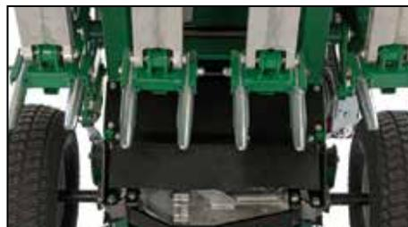
**Rápido mantenimiento de dientes** Solo 8 dientes y 4 pernos a los que se accede fácilmente y se necesita el 10 % del tiempo necesario para el mantenimiento de más de 40 dientes, unidades de tambor de 2 pernos.
