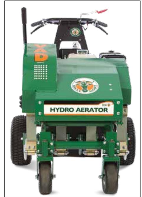
La **productividad de aireación de 30" (76.2 cm) de ancho** se combina con una notable durabilidad, velocidad, profundidad de tapones, y la falta de necesidad de airear dos veces. Esta máquina se adapta a cualquier lugar al que usted tenga que ir y tiene una gran visibilidad de dientes para trabajos en bordes. No necesita máquinas grandes ni pequeñas.
