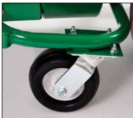
**Las duraderas ruedas pivotantes delanteras** se desplazan suavemente en los giros y en las superficies irregulares, lo que permite terminar rápidamente la tarea.
