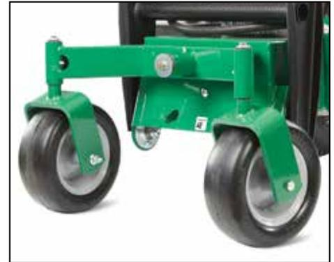
**Rueda pivotante delantera** para transportar sin problemas hacia el sitio de trabajo y desde una perforación a otra, junto con los neumáticos traseros para césped de alta flotación.
