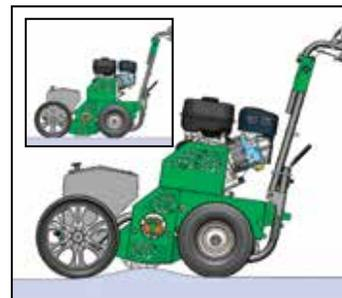
**Cabezal de corte flotante** con un carrete cortante de 22" (56 cm) exclusivamente diseñado, que se adapta a los contornos del césped; esto aumenta el contacto de la semilla con el suelo y mejora las tasas de germinación.
