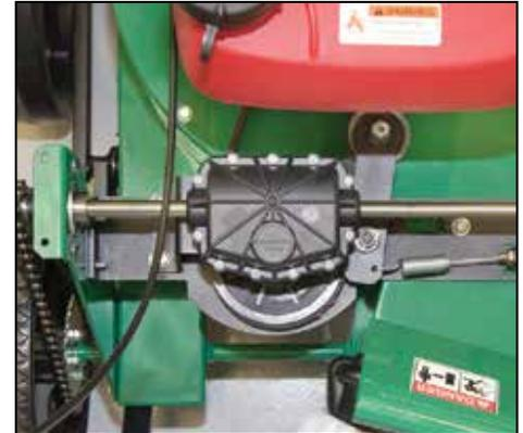
La unidad autopropulsada de transmisión trasera con una sola velocidad es excelente para aplicaciones en césped y pendientes. (KV601SP, KV650SPH y TKV650SPH, exclusivamente)
