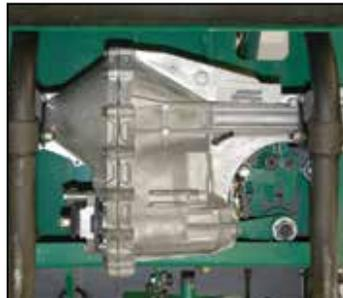
**La transmisión hidrostática auto-propulsada** con controles de transmisión de avance y retroceso intuitivos elimina la necesidad de empujar, lo que reduce la fatiga. Interruptor de liberación automática simple para el transporte en la posición de apagado.
