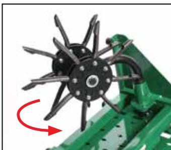
**Ruedas de dientes giratorias** para una maniobrabilidad superior (cuando se utilizan con enganche de 3 puntos). Poseen 80 dientes de acero reforzados para una extracción de tapones más eficiente.
