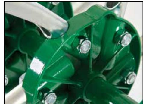
**Sujetador de dientes de un solo perno** Firme y de fácil mantenimiento. Con 50 % menos pernos que otras unidades del mercado.
