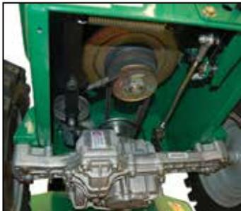
**El transeje hidrostático Tuff Torq™ con control de tracción mejorado** (Enhanced Traction Control, ETC) es totalmente automático; detecta cuando la rueda trasera comienza a girar, la bloquea y le proporciona tracción positiva. Proporciona tracción superior en pendientes o condiciones húmedas o irregulares.
