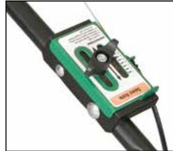
**El sistema Auto Drop™** es fácil de ajustar, y cuenta con tasas de caída para las diversas semillas enumeradas en las instrucciones incorporadas en la unidad.
