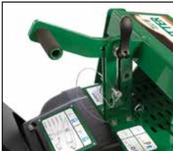
**Ajuste de profundidad de hoja Set and Forget™ a 2.5"**
