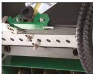
Démarré et arrêté automatiquement la chute des graines avec l'engagement de la bobine. Permet de réduire les pertes de graines.
