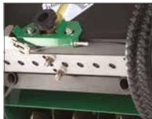
Startet und stoppt automatisch den Samenabwurf mit der Einrückung und Ausrückung der Walze, spart wertvollen Samen.
