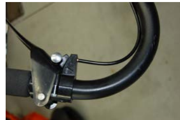
Hyvin ohjattu kaapeli
