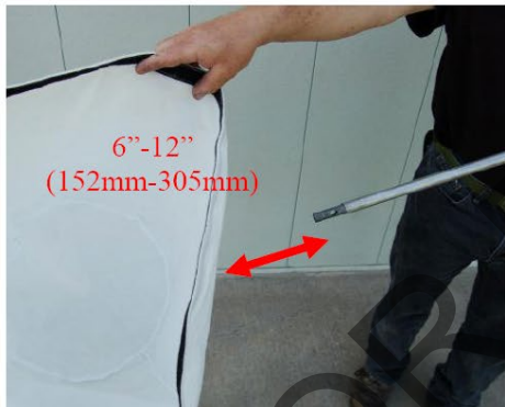
LIMPIE LIGERAMENTE CON AIRE COMPRIMIDO SOLAMENTE, DESDE DENTRO HACIA FUERA. MANTENER LA BOQUILLA ENTRE 15-30 CENTIMETROS DEL TEJIDO
